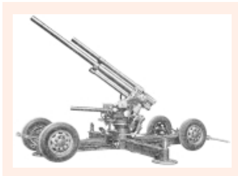
7,5 cm lvkanon m/30 – 37 närmar sig i konstruktionen m/37, som du ser på nästa sida. Fältlavetten gör att omgrupperingen går snabbare.
